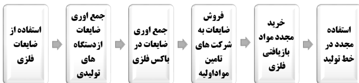
شکل شماره ۱- مسیر سنتی استفاده مجدد از ضایعات فلزی ماشین آلات صنعتی
